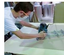
独自製作した治具を使った作業の様子
