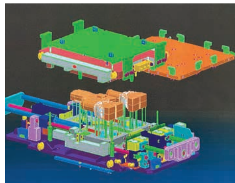
量産金型の設計後シミュレーションのようす。良い金型がなければ良品は生まれません。
