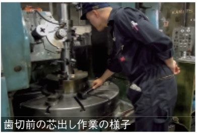
歯切前の芯出し作業の様子
