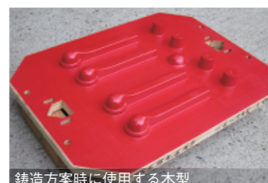
鑄造方案時に使用する木型
