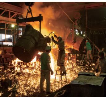
溶かした鉄を流し込む「湯入れ」
