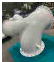
エルボ ポンプ浚渫船の土砂排送の際に、それらの通り道となる重要な役目をする配管。
