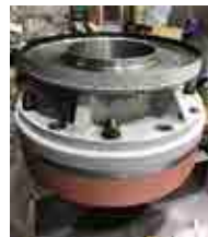
ラダーキャリア 船舶の舵取り軸受であり、船の重量を支えると同時に回転を円滑にするベアリングであります。一般に舵軸材の軸受と一体になっているものが多い。
