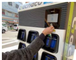
▲バッテリー 交換機
