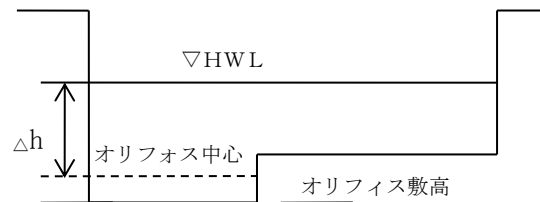
図 3-6 ヘッド差 \Delta h の考え方
