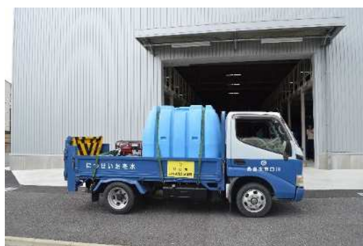
応急給水車（2 t 給水タンク＋発電機＋圧送ポンプ）
