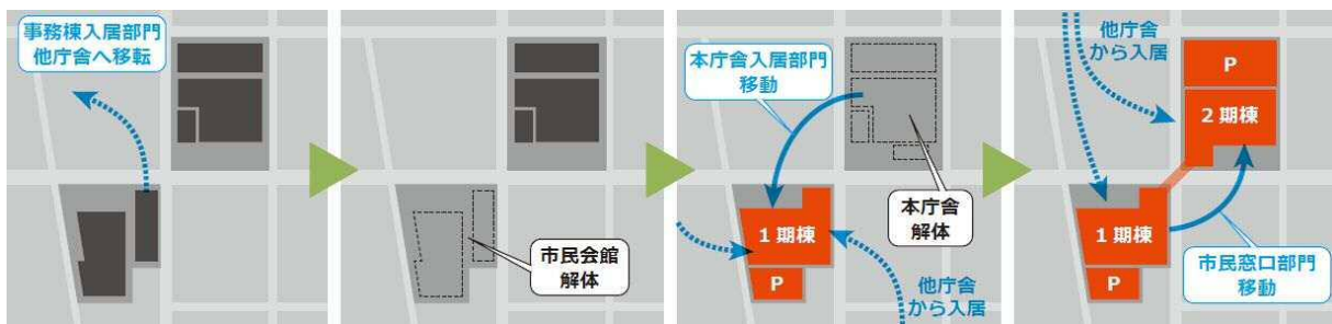
新庁舎建設工事ローテーションのイメージ
