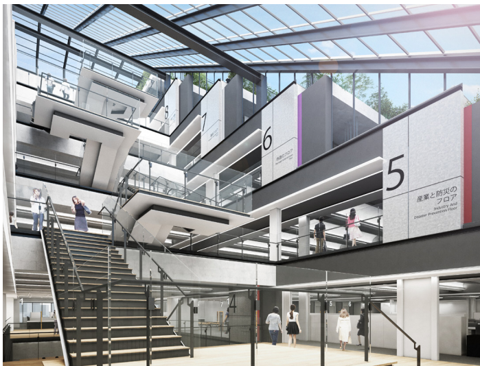
4階から見るシビック・キューボラの内観イメージ：視覚的・動線的に各層をつなぐシビック・キューボラ（吹抜空間）を通じて、どのフロアにも行きやすい計画
