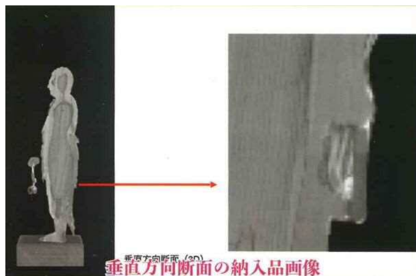
7. 《木造不動明王立像》X線CT画像（垂直方向断面）
