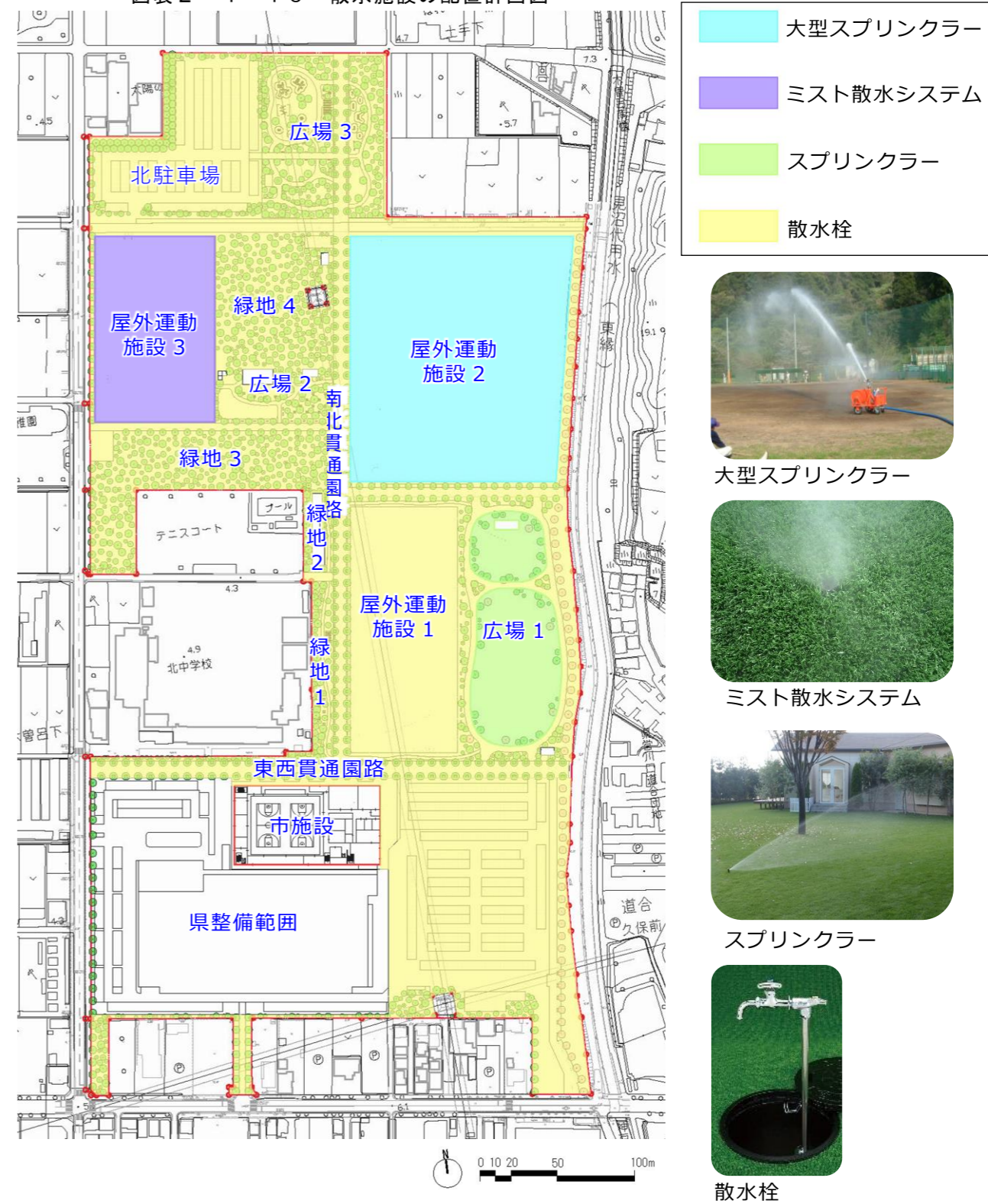
図表2-4-16 散水施設の配置計画図
