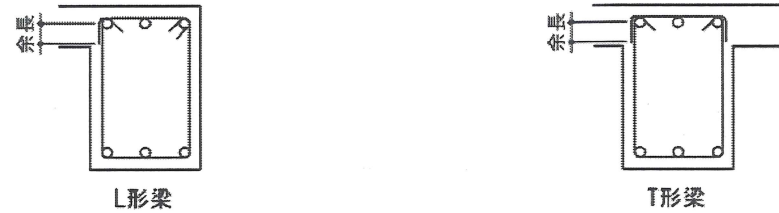
図2-3-4 あばら筋・帯筋の形状(溶接閉鎖形の場合)
