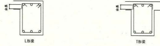
図2-3-4 あばら筋・帯筋の形状(溶接閉鎖部の場合)
