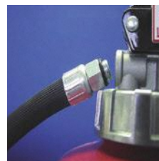
× 緊結ネジの破損 × ホースの脱落
