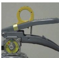
× レバー支えの脱落
