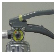
× 安全栓の脱落
