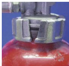
× キャップの破損
