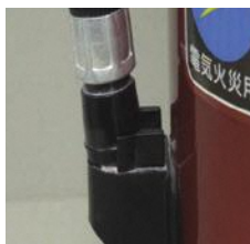
× 消火薬剤の漏れ
