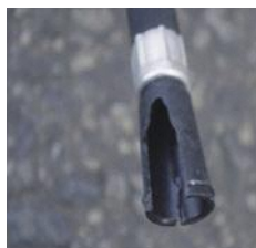
× ノズルの破損
