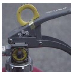
× 表示装置の脱落
