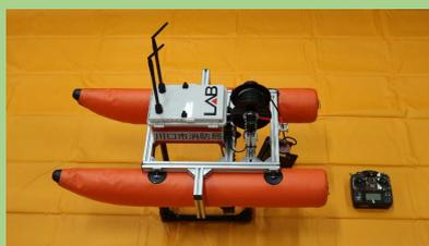
リモコン操作で船上のカメラを水中に降下させて、水中の画像を確認できる資機材です。GPS搭載で川の流れの中でも要救助者を発見した位置を自動保持できます。
