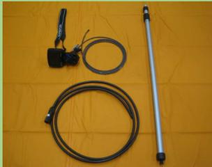
伸縮棒先端にある小型カメラで、内部の映像を確認できる資機材です。
