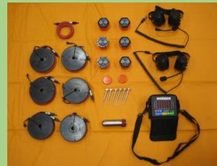
倒壊家屋やがれき、土砂等に閉じ込められた、人のわずかな音や振動をキャッチし、位置を特定する資機材です。
