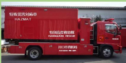
特殊災害対応資機材や遠距離大量送水システムを災害に合わせて積み替え出来るコンテナ式の車両です。
