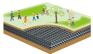
プラスチック製ブロックを地下に積み上げ、貯留スペースを生み出す
