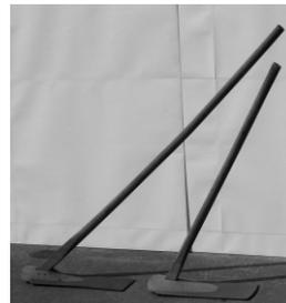
刃の部分が一枚からなるクワです。土を掘り返すだけでなく、刃先の部分を使って田の畦に土を塗り、叩いて引き締める作業にも使われました。耕し方によって柄の長さや柄と刃の角度もさまざまです。
