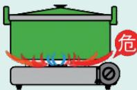
複数のカセットコンロを連続して置いたり、ガスボンベの上を覆う大きな鉄板や鍋は、カセットボンベが加熱されて危険です。
