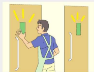
吊り引き戸の隙間へのアルミテープの貼付例
