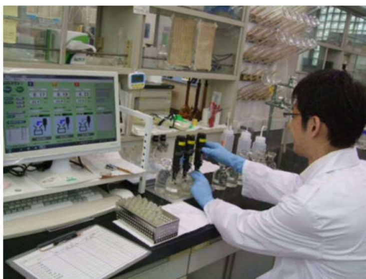
図 2.4.3 BOD（生物化学的酸素要求量）の測定
