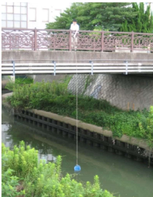
図 2. 4. 2 河川採水の状況（藤右衛門川（論處橋））
