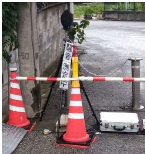
図2.7.2 自動車騒音・道路交通振動測定状況（県道さいたま鳩ヶ谷線）
