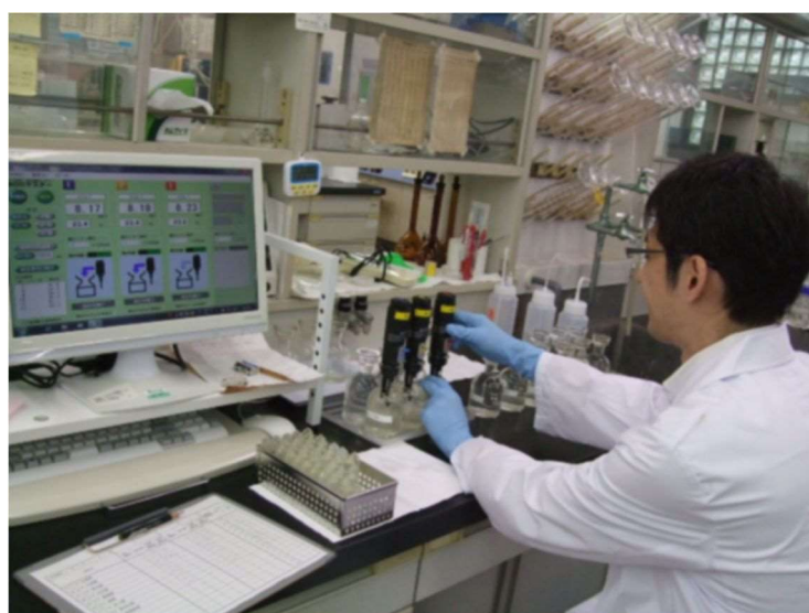
図 2. 4. 3 BOD（生物化学的酸素要求量）の測定
