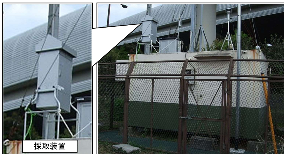
図 2.1.14 試料採取の状況（神根測定局）
