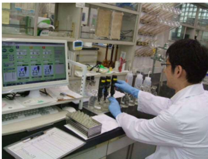
図 2.4.3 BOD（生物化学的酸素要求量）の測定
