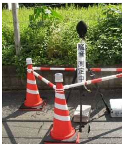
図 2.7.2 自動車騒音・道路交通振動測定の様相（県道金明町鳩ヶ谷線）
