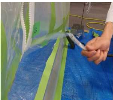
図 4-13 スモークテスターによる確認
