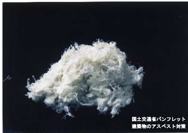
白石綿（クリソタイル）
