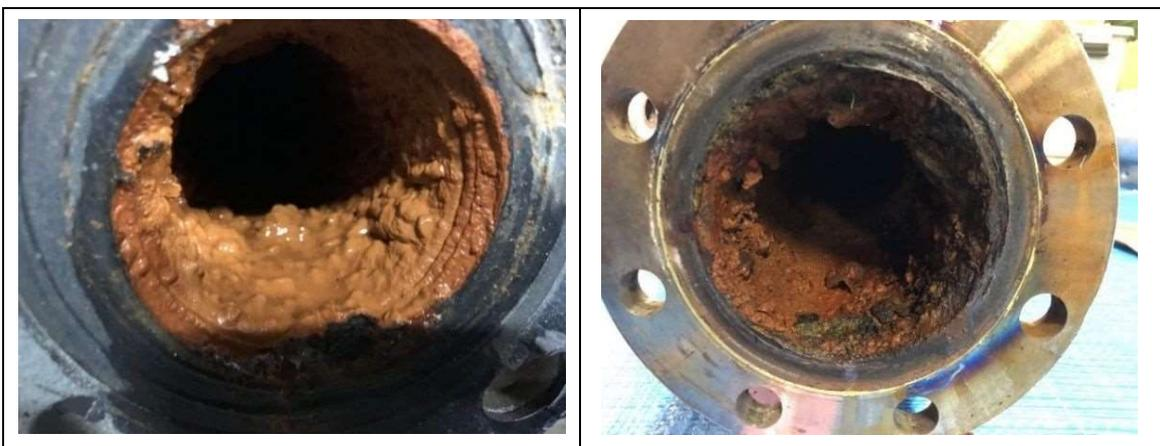
図 69 サンアール朝日の4階機械室内余熱配管の状況
