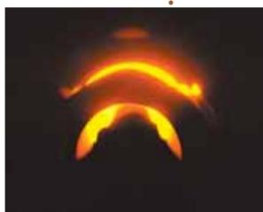
溶融炉で約 1500℃の熱で原料が溶かされます。
