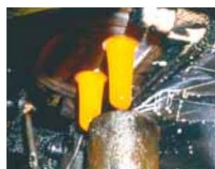
溶かされたガラスは適正温度に調整され、ゴブというガラスのかたまりにカットされます。
