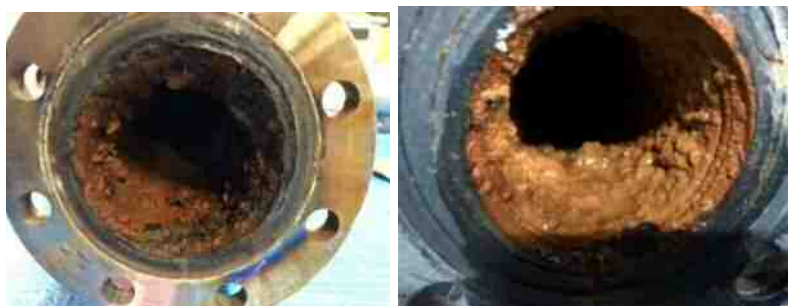
図 4-3 サンアール朝日の 4 階機械室内余熱配管の状況
